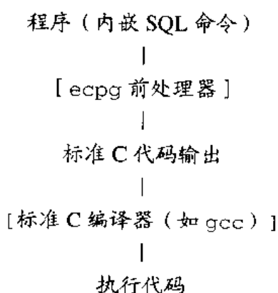
图 13-1 通过 ecpg 创建程序的流程
